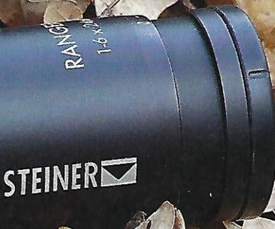
**ZeroStop:** Nach dem Einschießen kann der Nutzer die Türme nullen. Das erleichtert das Verstellen.
